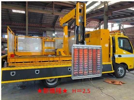
**特長:** タイル表面を3分間加熱すると、樹脂系接着剤、モルタル接着剤を問わず、ケレン棒で簡単に剥離します。タイル表面温度は300°Cになりますが、コンクリート強度には影響しません。
